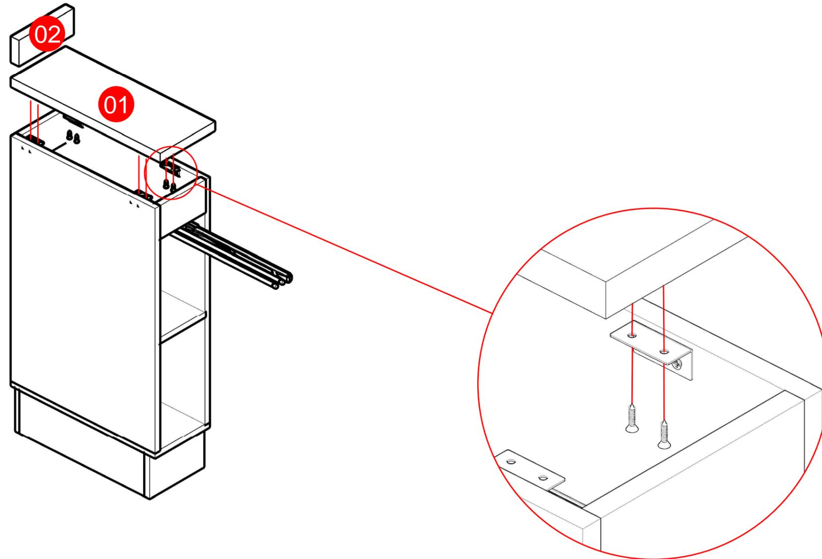
**MONTAGEM:** COM AS CANTONEIRAS METÁLICAS JÁ FIXADAS, INSIRA O TAMPO (01) SOBRE O BALCÃO EMPARELHANDO COM A PARTE DE TRÁS DO MÓVEL.
