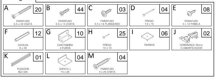
**Importante:** este produto possue parafusos 4,0x25 para fazer a união dos módulos montados. **Observação:** as laterais do produto não possuem furações para essa fixação, portanto após encostar um módulo ao outro, transpasse as laterais com os parafusos 4,0x25 para fazer a união.
